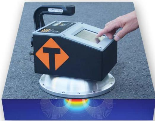
Das PQI 380 nutzt das Verfahren der **Impedanzspektroskopie**, um die elektrische Reaktion von Asphalt zu messen, aus der die Dichte berechnet werden kann.
